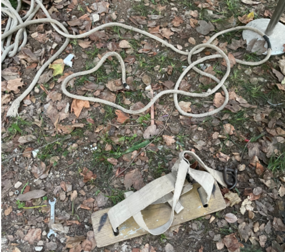
图1事故座板式单人吊具
