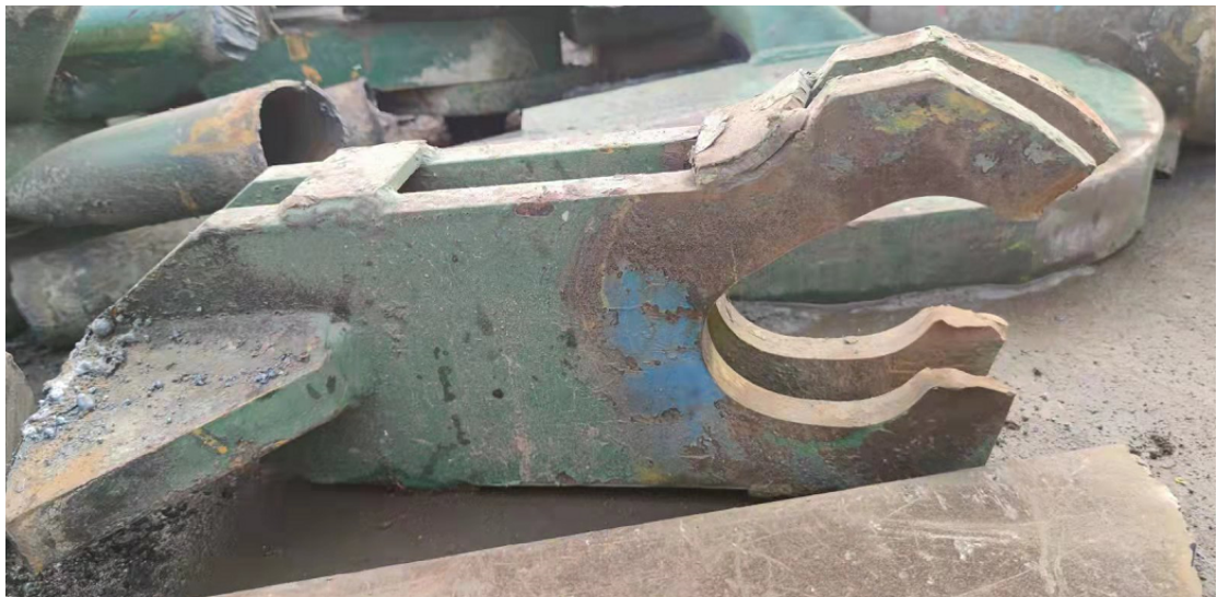
图5 事故塔式起重机分头拉板
