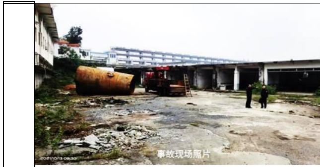
事故现场有一个圆柱形油罐，该油罐长度为6米，直径为2.9米，油罐中部有隔板，中间隔板距西侧焊口位置为3.5米，两端封口钢板爆炸后已经飞离，东侧封口钢板飞离位置距离油罐7.5米，西侧封口钢板飞离位置距离油罐25米，均呈U型弯曲型，罐体钢板厚度为5毫米，罐体焊口采用罐体外侧单面施焊焊接，经实际测量并计算该油罐的理论容积为39.6 m<sup>3</sup>，理论重量为2.9吨。事故现场圆形油罐距北侧4层建筑物距离4米，距离东侧红色汽车随车吊1.5米。汽车随车吊车辆成东西停放，车头朝东，北侧靠近油罐侧轮胎部分烧毁，地上遗留大量火烧后留下的碳粉痕迹，油罐内壁可见大火烧蚀痕迹，油罐与汽车随车吊间遗留一残留割炬及氧气乙炔气管带。
