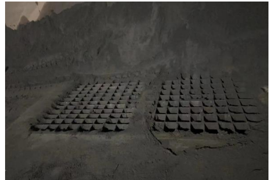
图2 下料口两个铁制篦子
