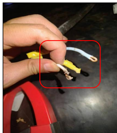
图 3 顶棚上的蛇皮管护套照明线路 图 4 外露的金属线芯
