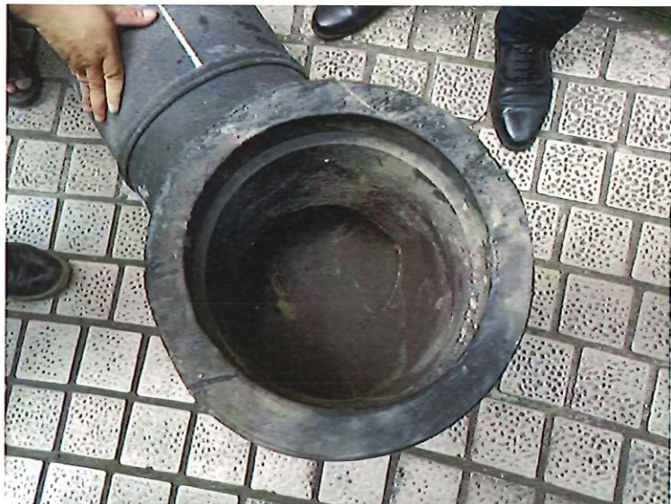
图 5b 泄漏处弯头 2 端面状态
