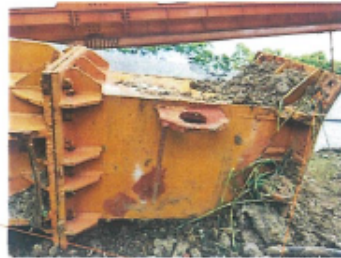
立柱与横梁连接板弯曲破坏
