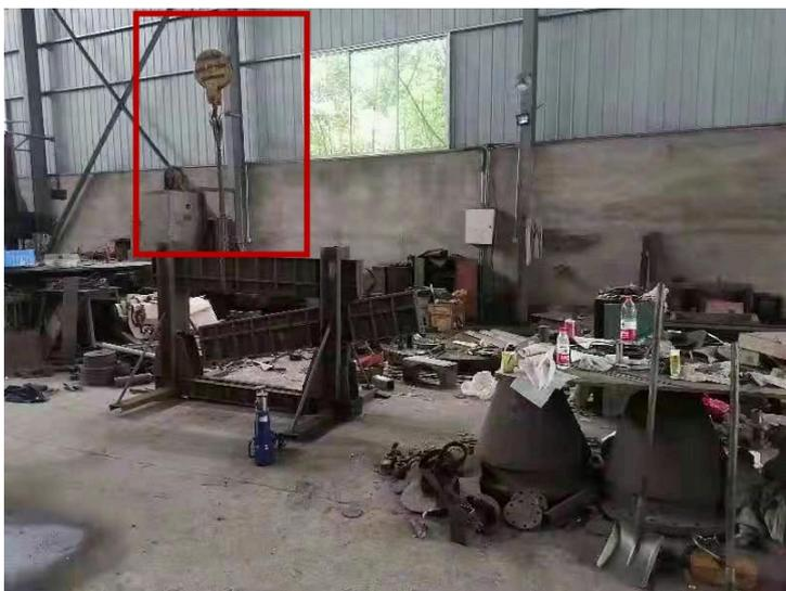
2.自制折板机, 设备几何尺寸: 长1950mm,宽750mm, 高1350mm, 整体重量640kg; 驱动方式: 纯手动; 工作原理: 折边机主要由上梁、下梁、折边梁及床架等部分组成。本机床全部手动工作, 折边机下梁可放置工件, 工件靠挡块定位, 上梁固定, 下梁压紧, 然后利用折板上翻的原理进行折边, 通过更换折弯机模具, 从而满足各种工件的需求。设备负责人: 田旭如。(见下图)
