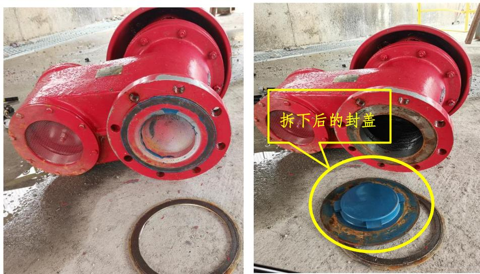
图 8 呼吸阀法兰面封盖拆除前后对比照片
