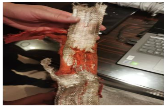
图6 吊装带环眼处断裂
