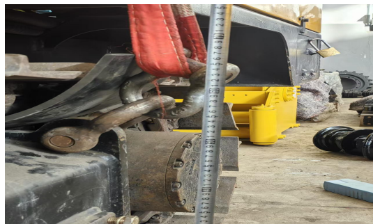
图 14 西边外侧吊点对地高度为 64cm
