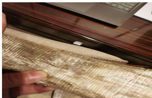
图 8 吊装带局部磨损
