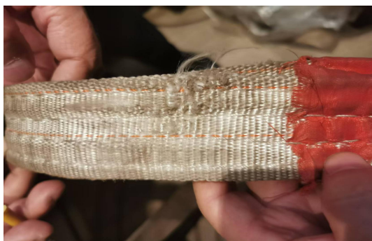
图 7 吊装带局部磨损
