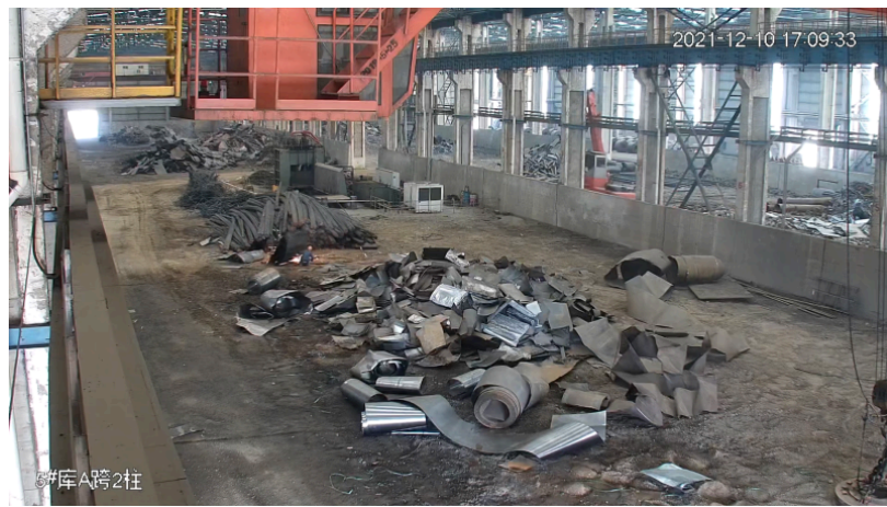
刘成学轴向切割废钢卷时，废钢卷回弹撞击压倒刘成学视频截图
