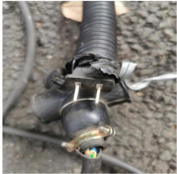
图-12 黑色防摔插座插口未接地线
