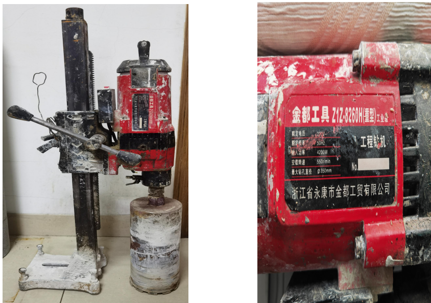
图 6: 钻孔取芯作业用钻机
