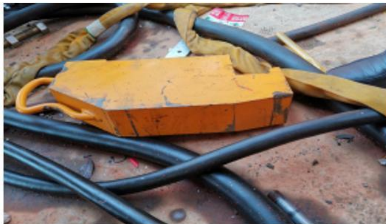
事故塔机坠落的爬爪（西北向）
