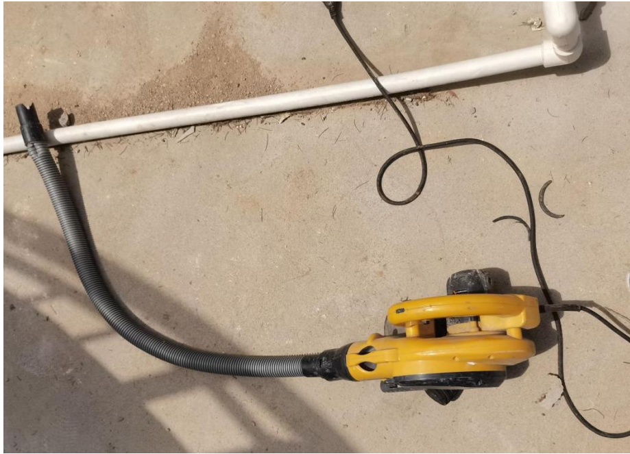
图5 通风使用的吹吸机
