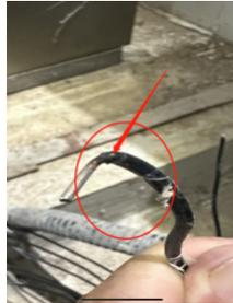
附图三：事故电缆编号为9号的电线裸露接头上有明显的打火烧焦现象
