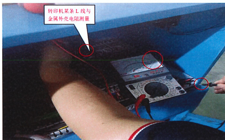
图 8 转印机脱落相线与外壳之间电阻测量图
