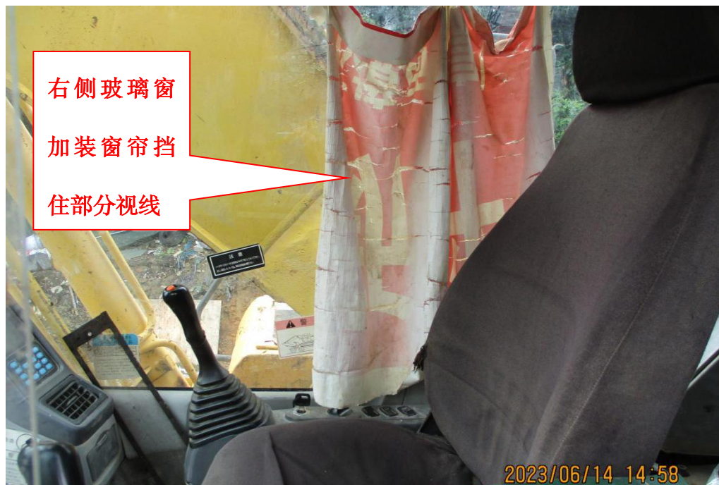
图6 涉事挖掘机驾驶室里面状况
