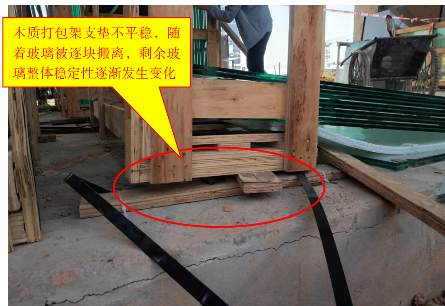
图7 事发玻璃包装底部木条垫高状态
