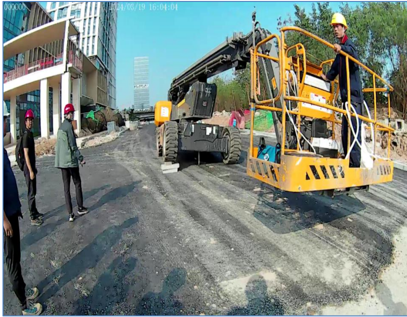
图 8 模拟“底盘倾斜大于 5^{\circ} ”报警试验
