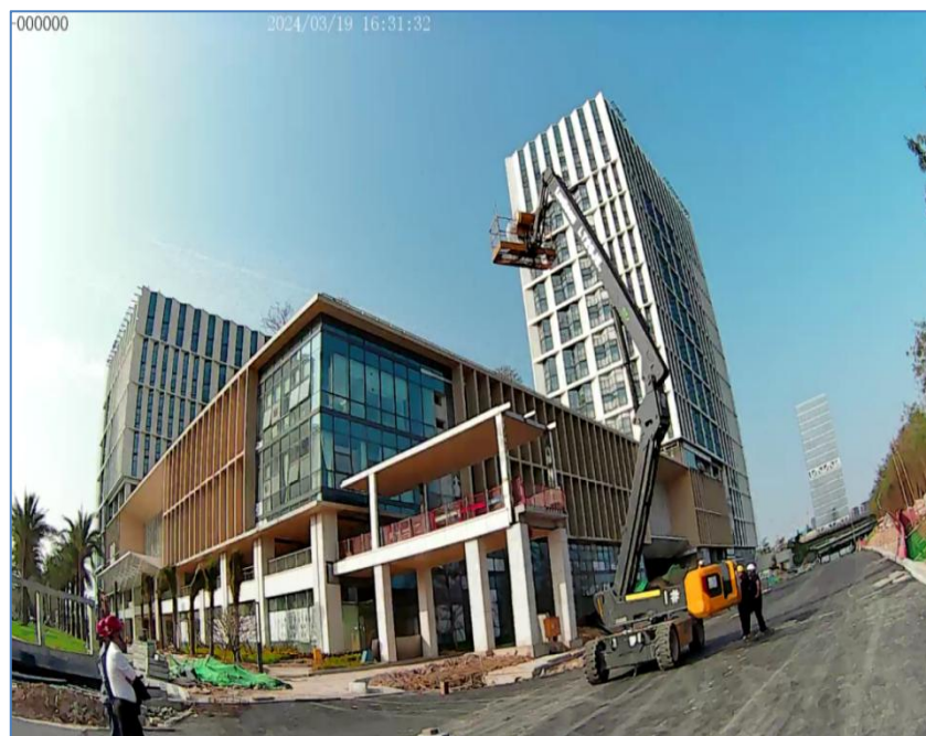
图7 模拟“臂架角度超过极限位置”报警试验
