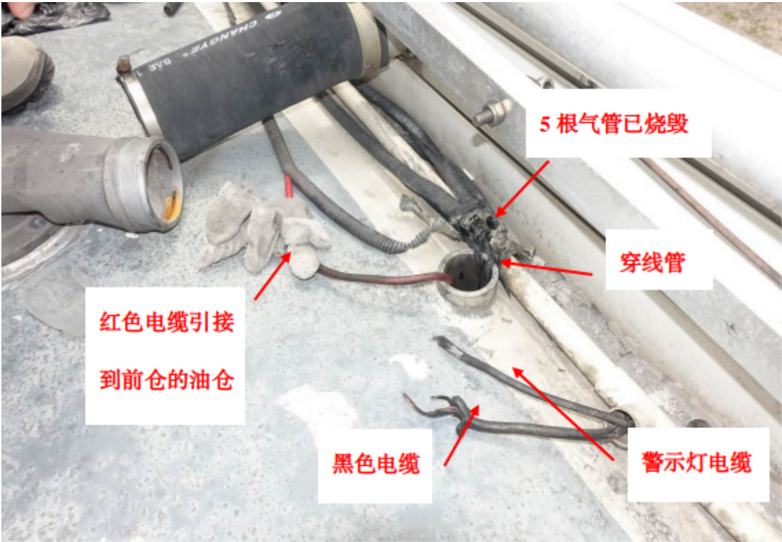
图7.穿线管管道的上端口附近
