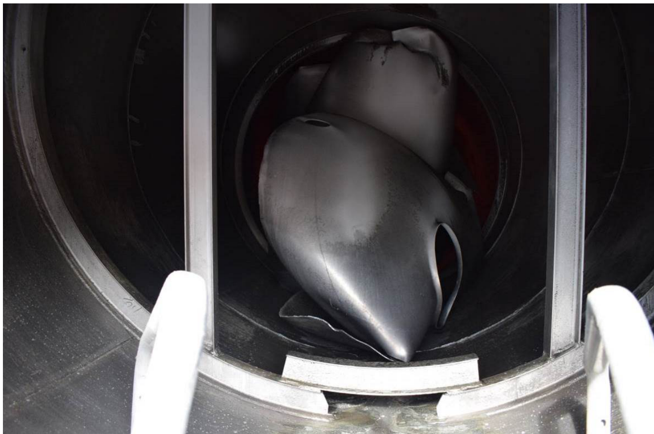
图2.2件防波板已卷曲变形且发生位移
