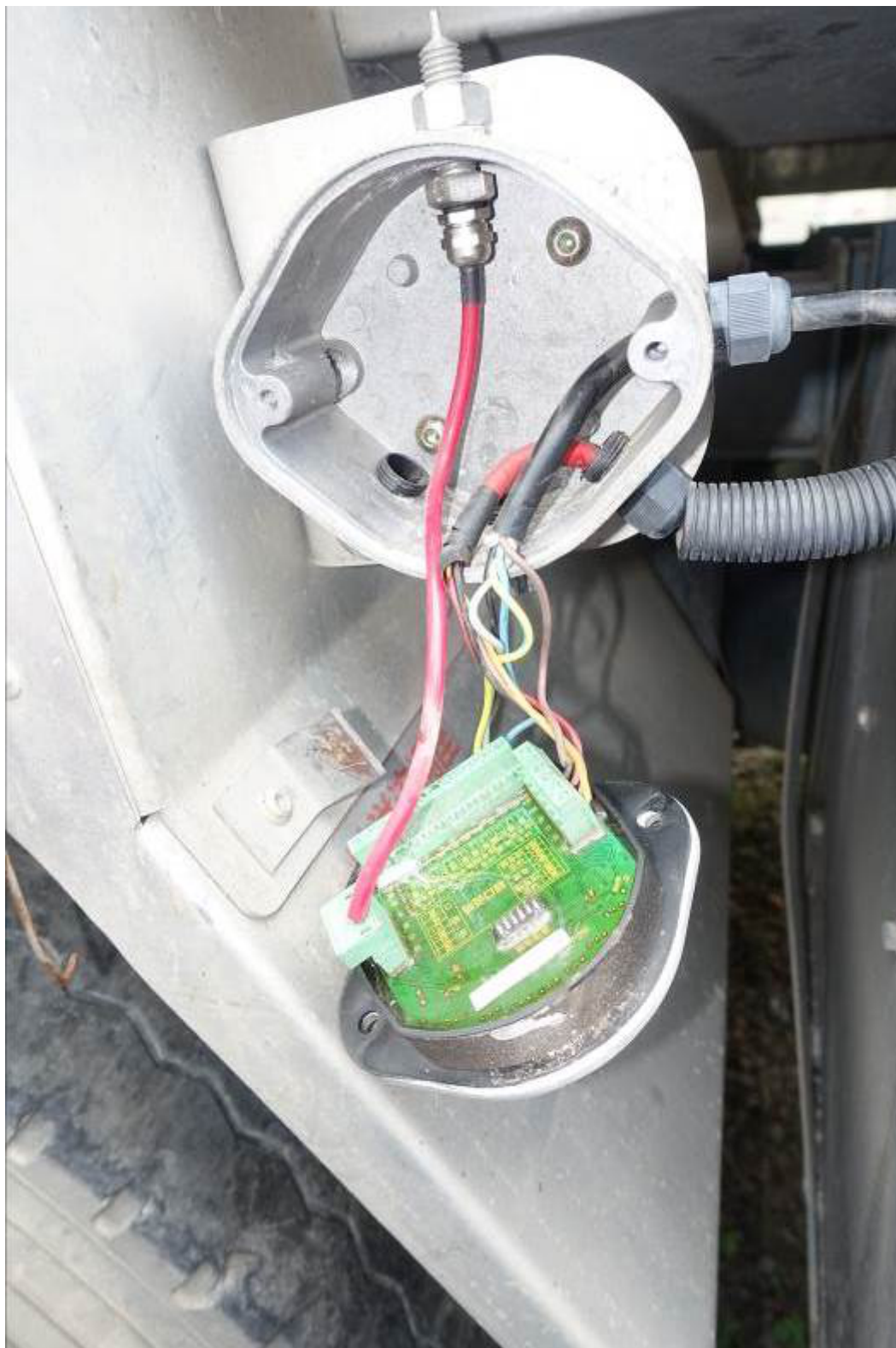
图6.溢油静电传感器的内部
