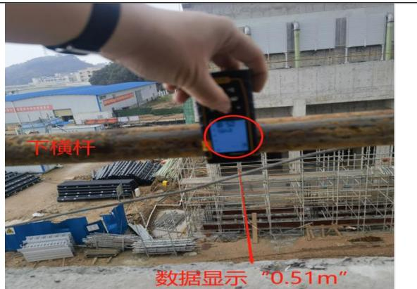
图 9 下横杆距离基准面高度图
