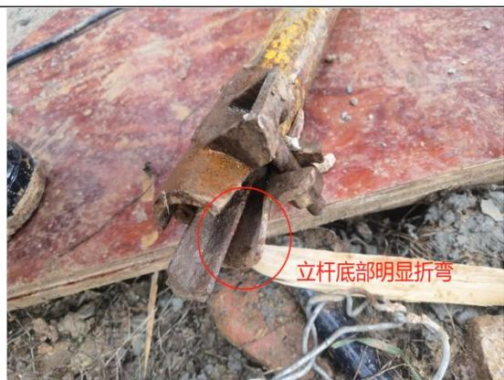
图 6 坠落立杆底部明显折弯
