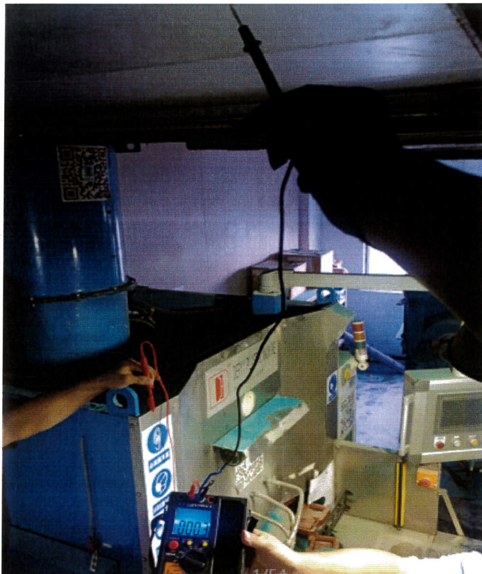
（图十 方形金属风管与设备外壳接地的联接性）
