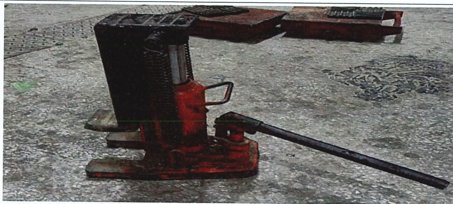
图 12 涉事作业使用的千斤顶
