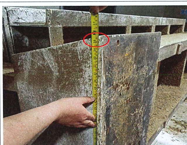
图 8 涉事冷压机底部宽 0.9m
