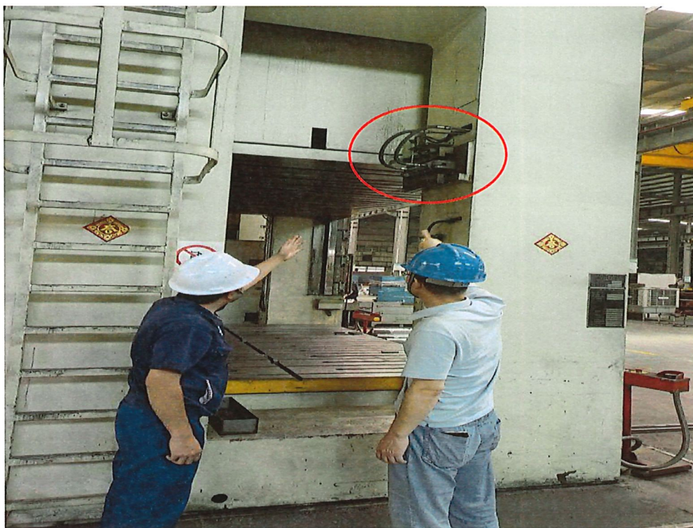
图 7 框架式液压机上滑块安全栓
